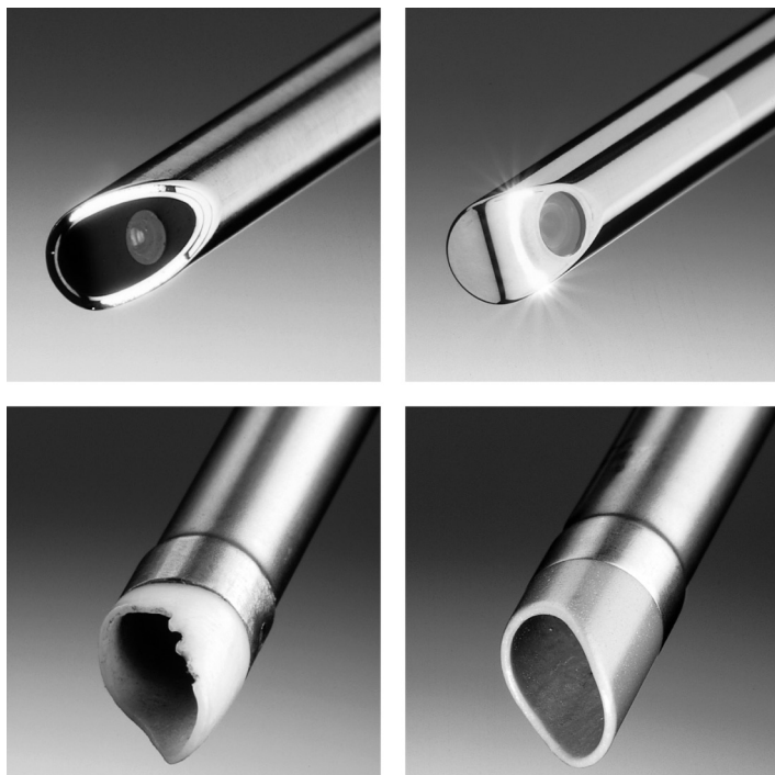
指定外サービスエンジニアによる修理（左）と指定サービスエンジニアによる修理（右）の比較
